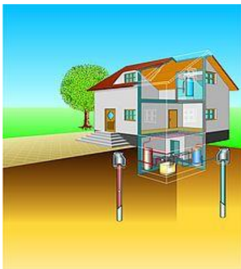
Slika 5: Toplotna črpalka voda/voda [5]
